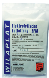
Avfetting 50g, blandes i 1l destillert vann. Brukes ved 20-25° og 7-8V i ca 1min. 312171
