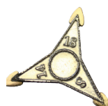
Prøvestjerne For å lage sammenlignings- streker på prøvesteinen. 204160
