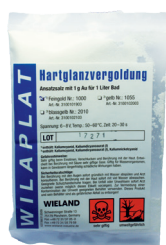
Forgylling for elektrolyttisk forgylling. Pulver, blandes i 1l destillert vann. In- neholder 1g gull. Brukes ved 60-70° 6-8V i 20-30sek. 312172
